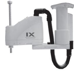
Typ Deckenmontage/invers Armlänge 500 mm Nutzlast 2 kg Nennlast/10 kg max.
