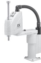
Typ Normalausführung Armlänge 800 mm Nutzlast 5 kg Nennlast/20 kg max.
