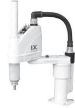
Typ Staub-/spritzwassergeschützt | Armlänge 500 mm | Nutzlast 2 kg Nennlast/10 kg max.
