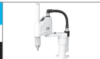
Typ Staub-/spritzwassergeschützt | Armlänge 500 mm | Nutzlast 2 kg Nennlast/10 kg max.
