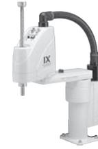
Typ Normalausführung Armlänge 500 mm Nutzlast 2 kg Nennlast/10 kg max.
