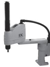
Typ Staub-/spritzwassergeschützt    Armlänge 800 mm    Nutzlast 5 kg Nennlast/20 kg max.
