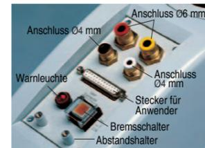
\*1 Unabhängig davon, ob der Bremsschalter betätigt wurde oder nicht, muss eine 24 V- Spannung zur Verfügung gestellt werden.
