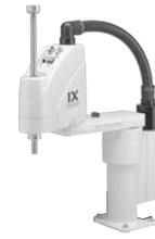
Typ Normalausführung    Armlänge 700 mm    Nutzlast 5 kg Nennlast/20 kg max.
