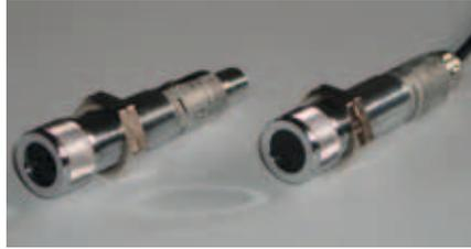
sind für kleinste bis mittlere Schaltabstände geeignet. Schaltfrequenzen bis 5 kHz sind je nach Typ möglich. Die heutige Version V2 ist ein verbesserter, volldigitaler Sensor mit integriertem Mikroprozessor. Das bedeutet wesentlich bessere Temperaturstabilität und exaktere Schaltvorgänge. Die Umschaltung der Ausgänge erfolgt mittels des eingebauten Potis, mit dem auch der Schaltabstand eingestellt werden kann. Die 18-er Universalensoren verfügen ebenfalls über zwei separate Ausgänge.
