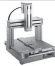
Typ Portal, 3-Achsen Hub X-Achse: 200 mm / Y-Achse: 200 mm / Z-Achse: 50 mm / 100 mm Zuladung X-Achse: 10 kg / Z-Achse: 2 kg
