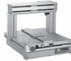
Typ Portal, 2-Achsen Hub X-Achse: 200 mm / Y-Achse: 200 mm Zuladung X-Achse: 10 kg / Y-Achse: 5 kg
